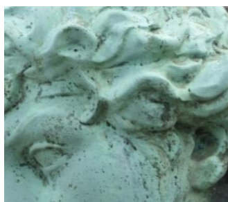
Oxydeert en wordt mat
