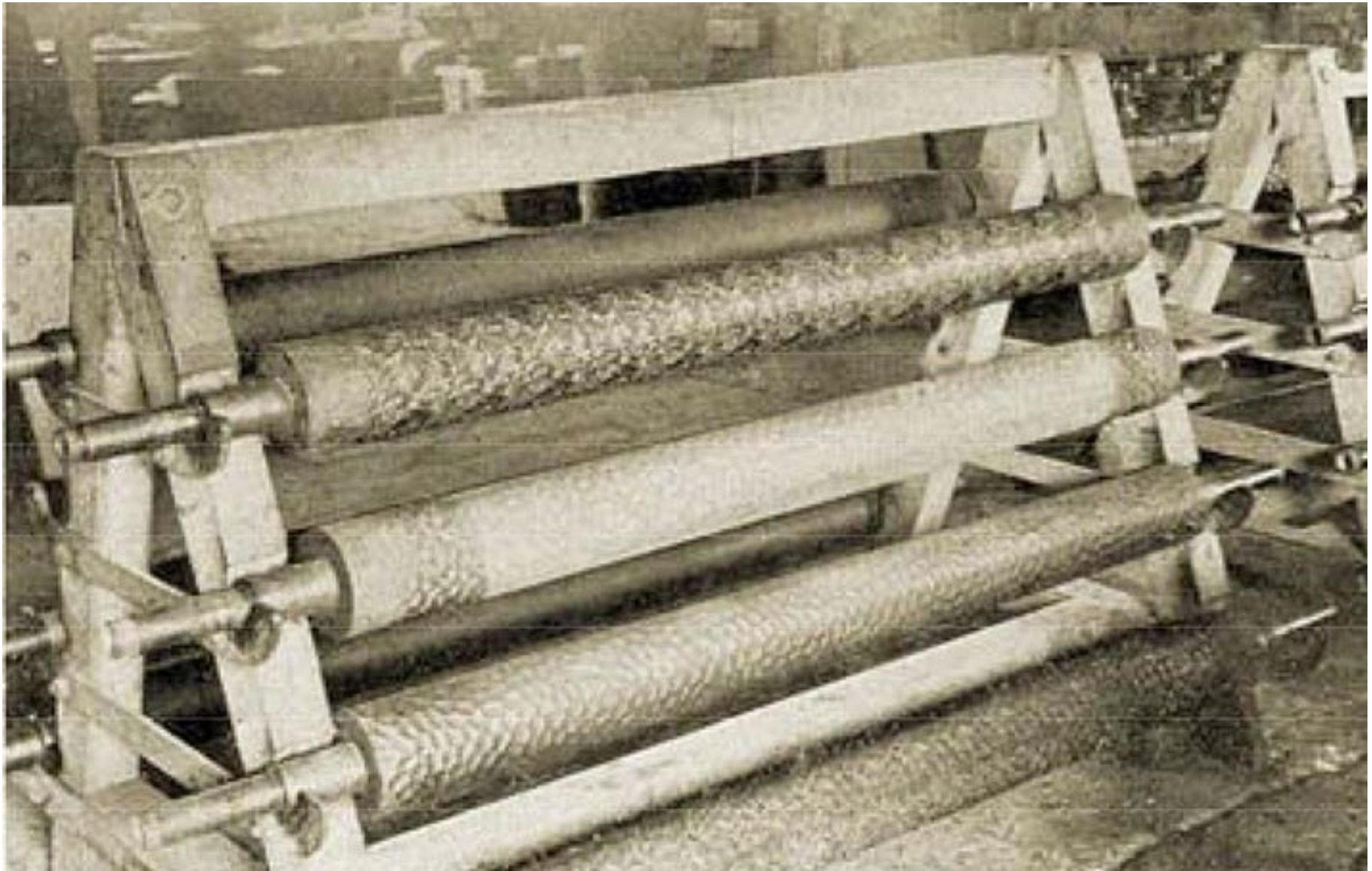
Rouleaux d'impression pour fabriquer du verre avec du relief
