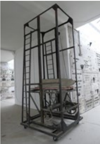
Lift om de grafkisten in hoger gelegen nissen te schuiven - Begraafplaats van Sint-Joost-ten-Node
