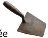
► Le mortier était fabriqué par le mortelieur ou gâcheur de mortier. Sa recette comprend un mélange de chaux (de la pierre cuite à très haute température et ensuite broyée), du sable (que l'on trouvait aussi dans les carrières) et de l'eau. Le mortier sert bien sûr à lier les matériaux, mais il peut aussi être utilisé comme enduit. Dans ce cas, il recouvre le mur pour unifier et protéger les matériaux.
