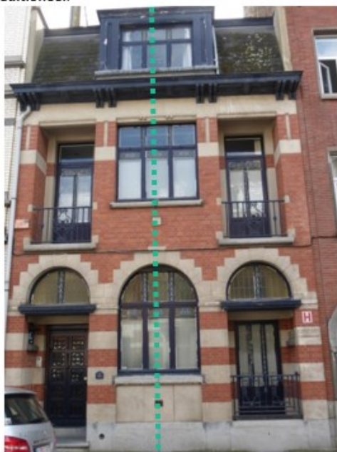
Bakstenen met simili (bepoistering ter imitatie van natuursteen). Het materiaal dat gebruikt wordt, is nog traditioneel .
